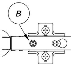
**а** - регулировка расстояния между дверью и корпусом
