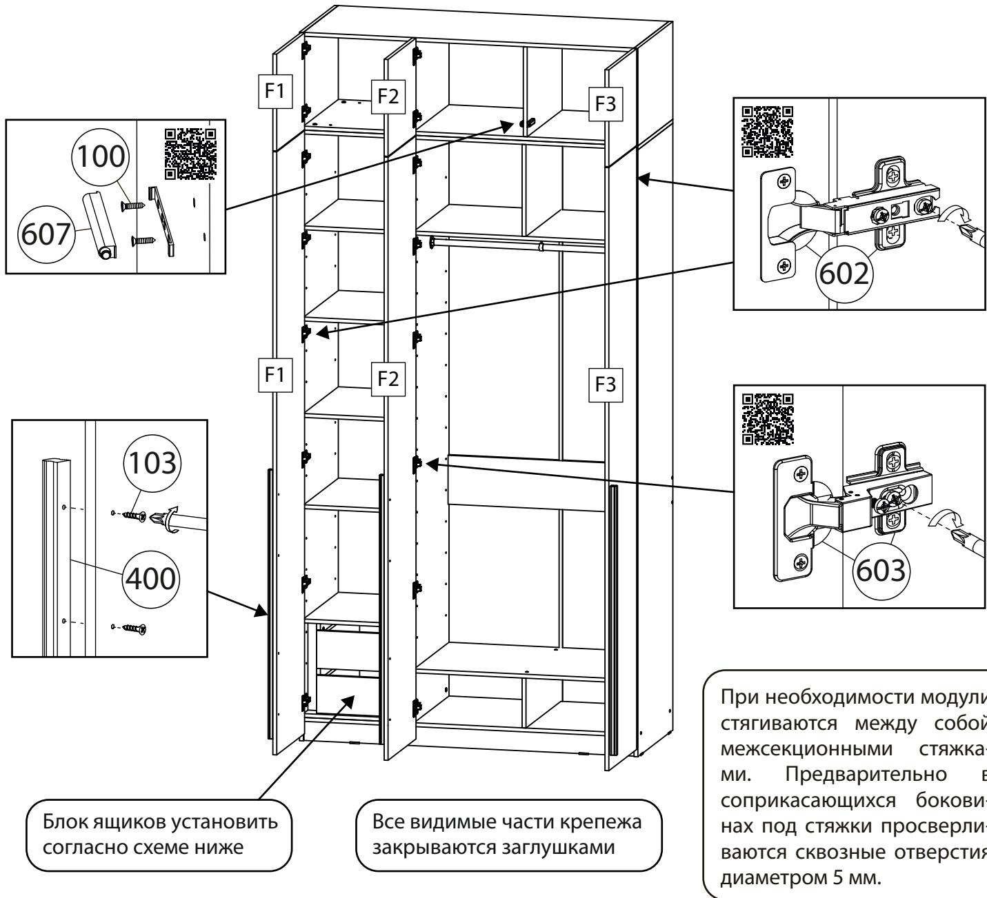
При необходимости модули стягиваются между собой межсекционными стяжками. Предварительно в соприкасающихся боковинах под стяжки просверливаются сквозные отверстия диаметром 5 мм.
