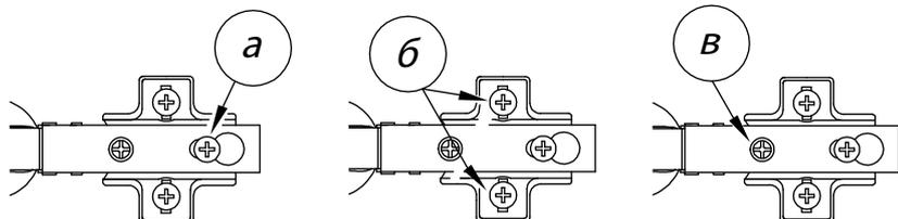
**а** - регулировка расстояния между дверью и корпусом
