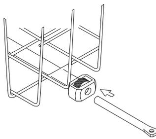
**d.** С помощью болта, вставленного в отверстие на плоской части крепежного цилиндра, и гайки привинтите корзину к ответной части направляющих.
