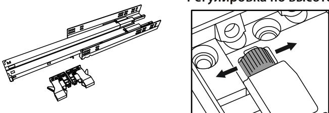
В комплект направляющих скрытого монтажа входят: фиксаторы левый и правый, направляющие левая и правая. Фиксаторы устанавливаются на дно ящика, а направляющие на боковины корпуса. Разъединение производится путем нажатия на рычаги фиксаторов. Если направляющие крепятся на одной боковине с двух сторон, то саморезы необходимо крепить в разные отверстия направляющей. Для регулировки выкатных ящиков по высоте необходимо повернуть регулировочное колесо на фиксаторе (см. рисунок).
