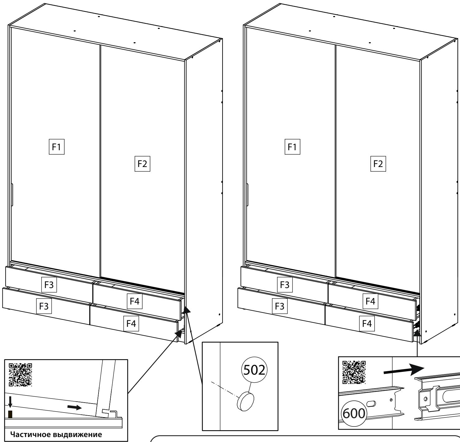
Выдвиньте подвижные элементы направляющих, вставьте ящик. Крючки направляющих должны войти в зацепление с отверстиями в задней стенке ящика. Опуская ящик вниз, нужно насадить стенки боковыми отверстиями на штыри направляющих. После установки ящика на направляющие отрегулируйте зазоры по высоте, вращая шайбу с накаткой.
