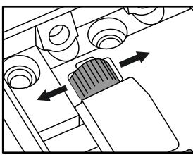
В комплект направляющих скрытого монтажа полного выдвижения входят: фиксаторы левый и правый, направляющие левая и правая. Фиксаторы устанавливаются на дно ящика, а направляющие на боковины корпуса. Разъединение производится путем нажатия на рычаги фиксаторов. Если направляющие крепятся на одной боковине с двух сторон, то саморезы необходимо крепить в разные отверстия направляющей. Для регулировки выкатных ящиков по высоте необходимо повернуть регулировочное колесо на фиксаторе (см. рисунок).
