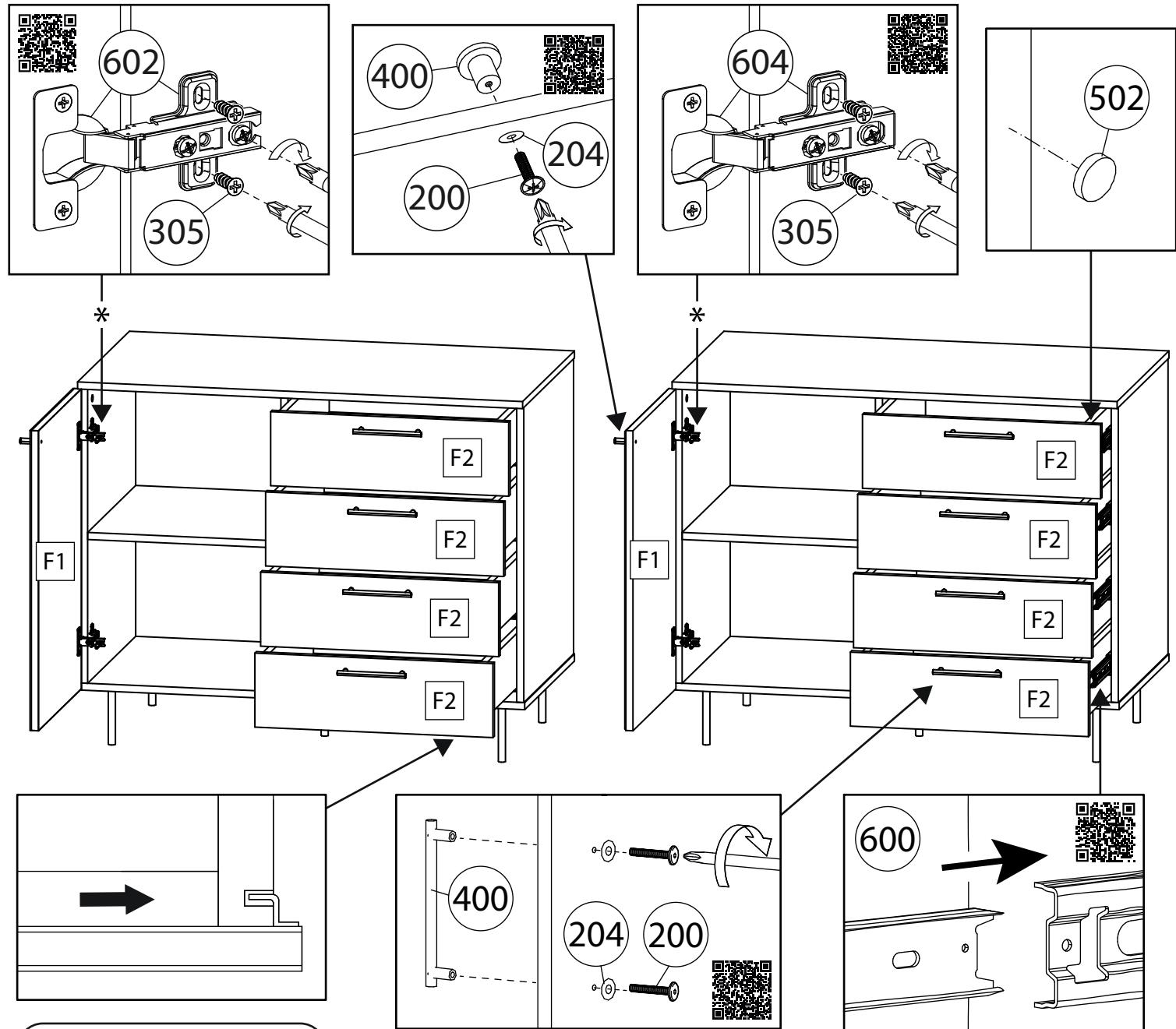
Выдвиньте подвижные элементы направляющих, вставьте ящик и задвиньте до щелчка. Крючки направляющих должны войти в зацепление с отверстиями в задней стенке ящика.
