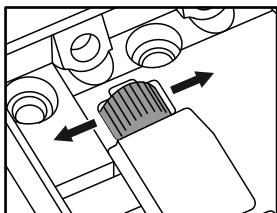
В комплект направляющих скрытого монтажа входят: фиксаторы левый и правый, направляющие левая и правая. Фиксаторы устанавливаются на дно ящика, а направляющие на боковины корпуса. Разъединение производится путем нажатия на рычаги фиксаторов. Если направляющие крепятся на одной боковине с двух сторон, то саморезы необходимо крепить в разные отверстия направляющей. Для регулировки выкатных ящиков по высоте необходимо повернуть регулировочное колесо на фиксаторе (см. рисунок).
