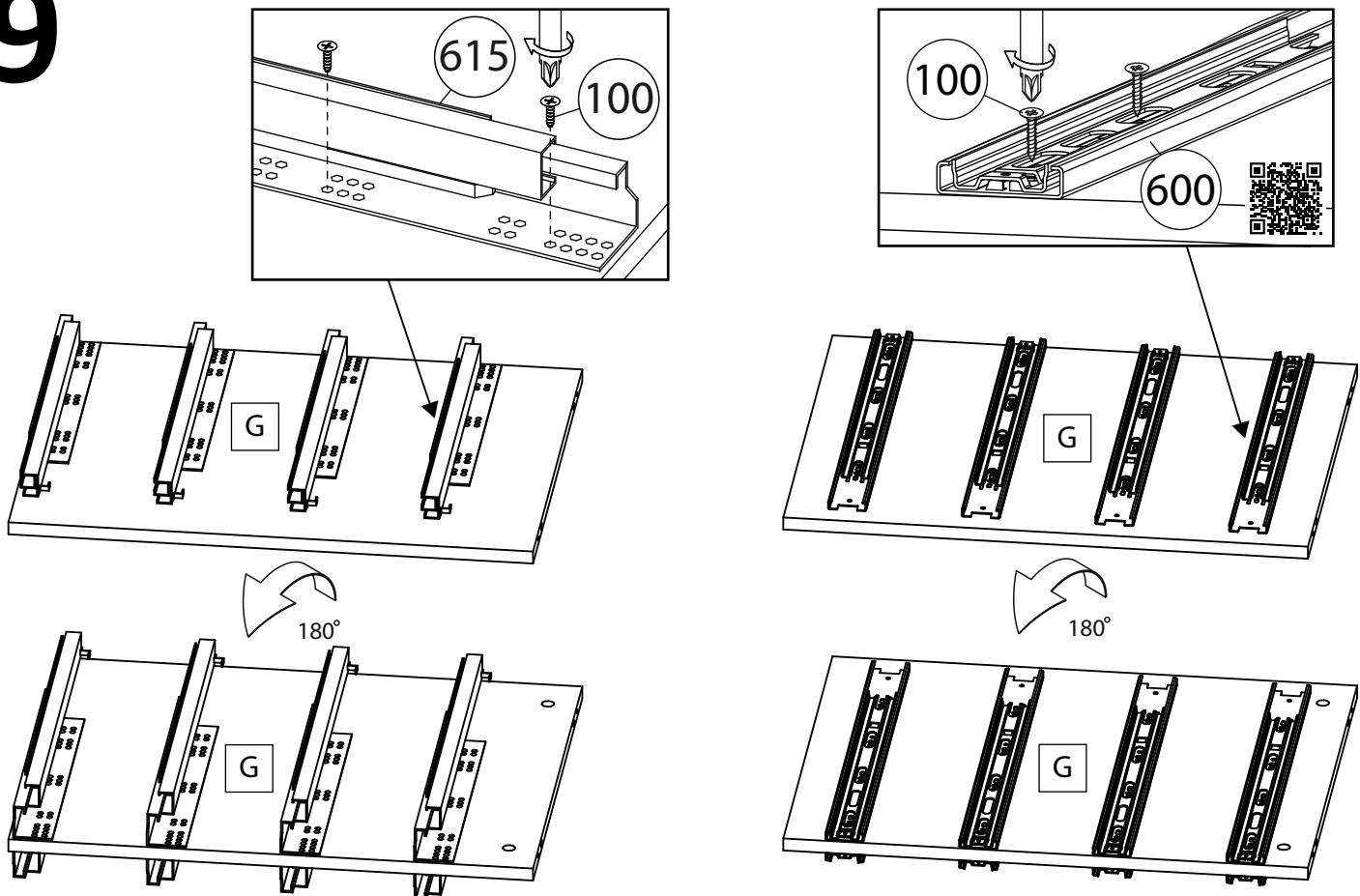
При установке направляющих с двух сторон не рекомендуется фиксировать саморезами в смежные отверстия
