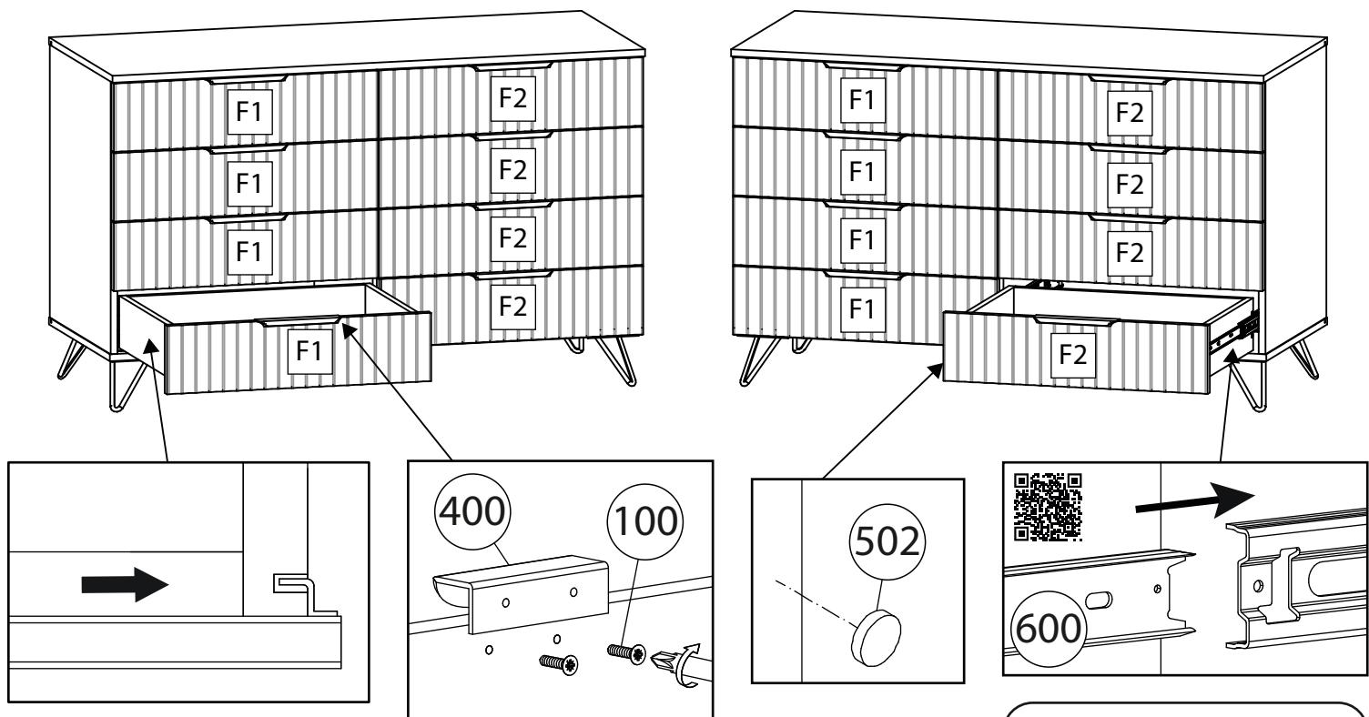
Выдвиньте подвижные элементы направляющих, вставьте ящик и задвиньте до щелчка. Крючки направляющих должны войти в зацепление с отверстиями в задней стенке ящика.
