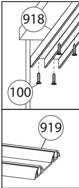
Закрепить верхнюю направляющую саморезами. Верхняя направляющая ставится заподлицо с боковыми стенками шкафа, нижняя направляющая ставится на дно с отступом 18 мм от края.
