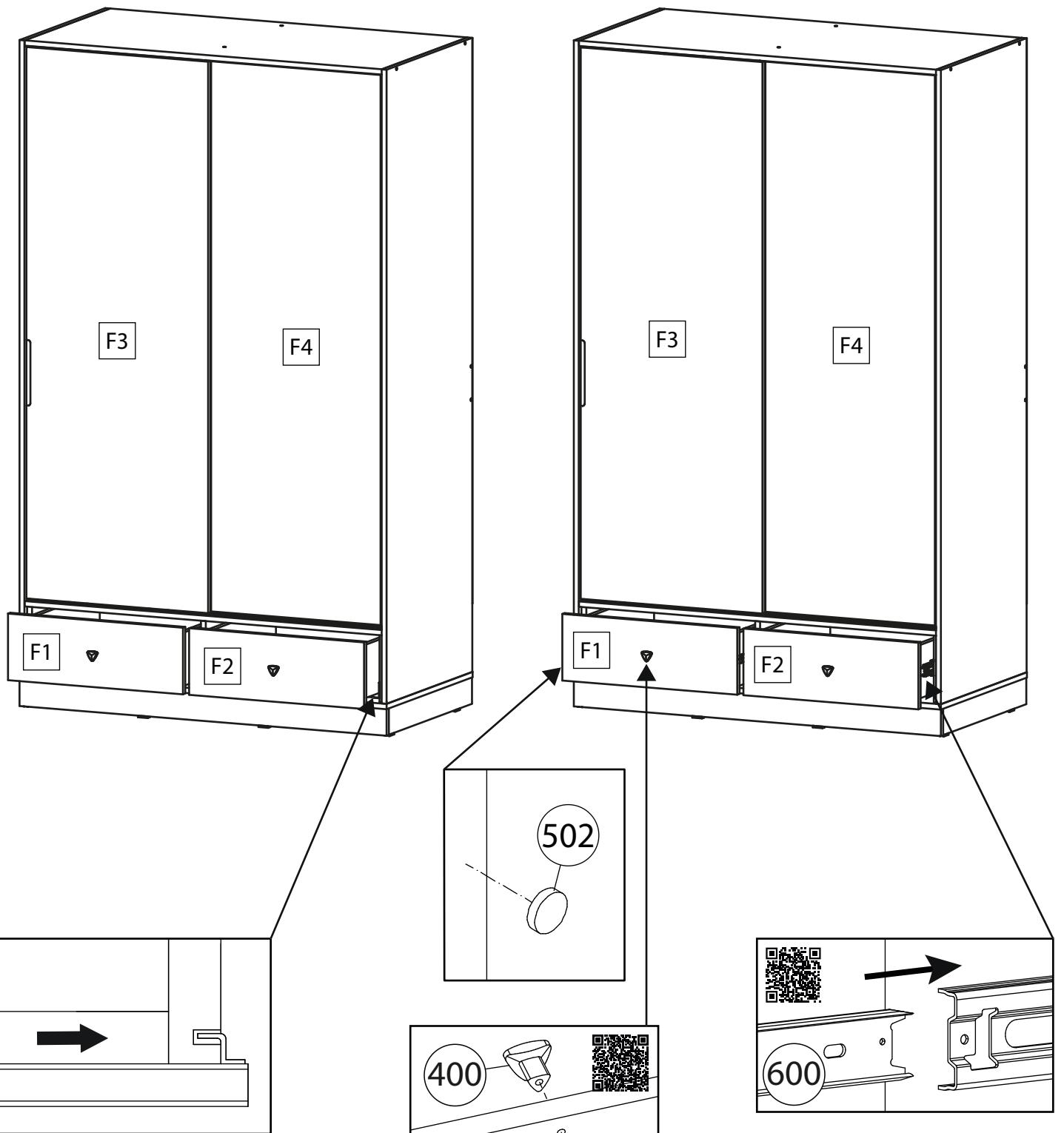
Выдвиньте подвижные элементы направляющих, вставьте ящик и задвиньте до щелчка. Крючки направляющих должны войти в зацепление с отверстиями в задней стенке ящика.
