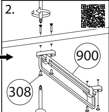
При глубине шкафа менее 500 мм вместо штанги устанавливаются выдвижные кронштейны (1 штанга = 1 кронштейн).
