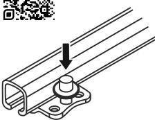
В комплект направляющих скрытого монтажа частично-го выдвижения не входят фиксаторы. Функцию фиксатора выполняет штырь направляющих.
