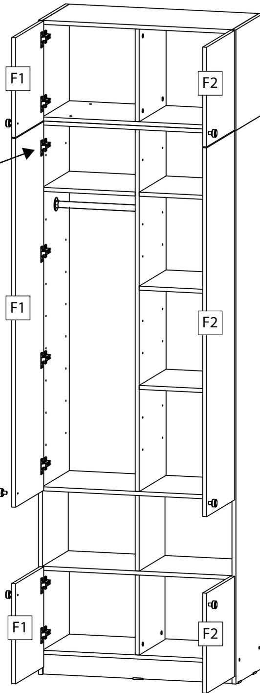
При необходимости модули стягиваются между собой межсекционными стяжками. Предварительно в соприкасающихся боковинах под стяжки просверливаются сквозные отверстия диаметром 5 мм.
