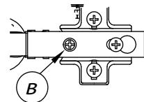
При необходимости модули стягиваются между собой межсекционными стяжками. Предварительно в соприкасающихся боковинах под стяжки просверливаются сквозные отверстия диаметром 5 мм.
