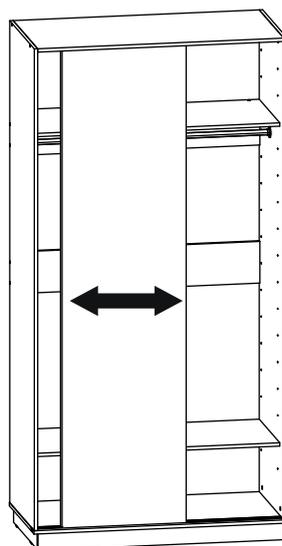
Регулирующим винтом на роликах выровняйте зазор между дверью и боковиной шкафа.
