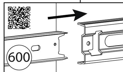
Выдвиньте подвижные элементы направляющих, вставьте ящик. Крючки направляющих должны войти в зацепление с отверстиями в задней стенке ящика. Опуская ящик вниз, нужно насадить стенки боковыми отверстиями на штыри направляющих. После установки ящика на направляющие отрегулируйте зазоры по высоте, вращая шайбу с накаткой.
