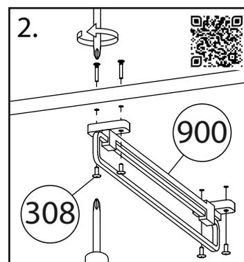
При глубине шкафа менее 600 мм устанавливаются выдвижные кронштейны вместо штанги (1 штанга=1 кронштейн)
