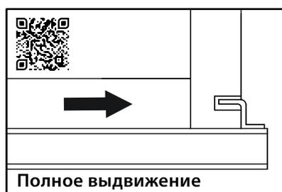
Выдвиньте подвижные элементы направляющих, вставьте ящик и задвиньте до щелчка. Крючки направляющих должны войти в зацепление с отверстиями в задней стенке ящика.
