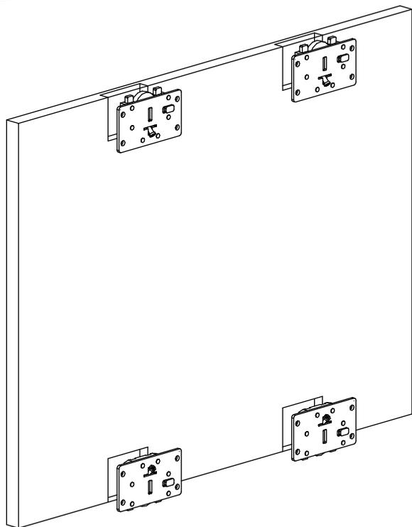
1. Установите ролики в подготовленные пазы и закрепите саморезами.
