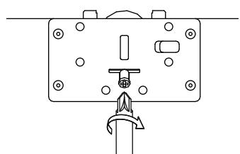
5. Сдвинуть доводчик задней двери таким образом, чтобы она полностью не перекрывалась передней дверью.
