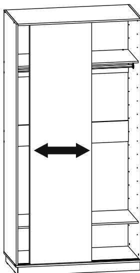
Регулировочным винтом на роликах выровняйте зазор между дверью и боковой шкафом.
