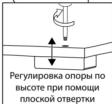
Регулировка опоры по
